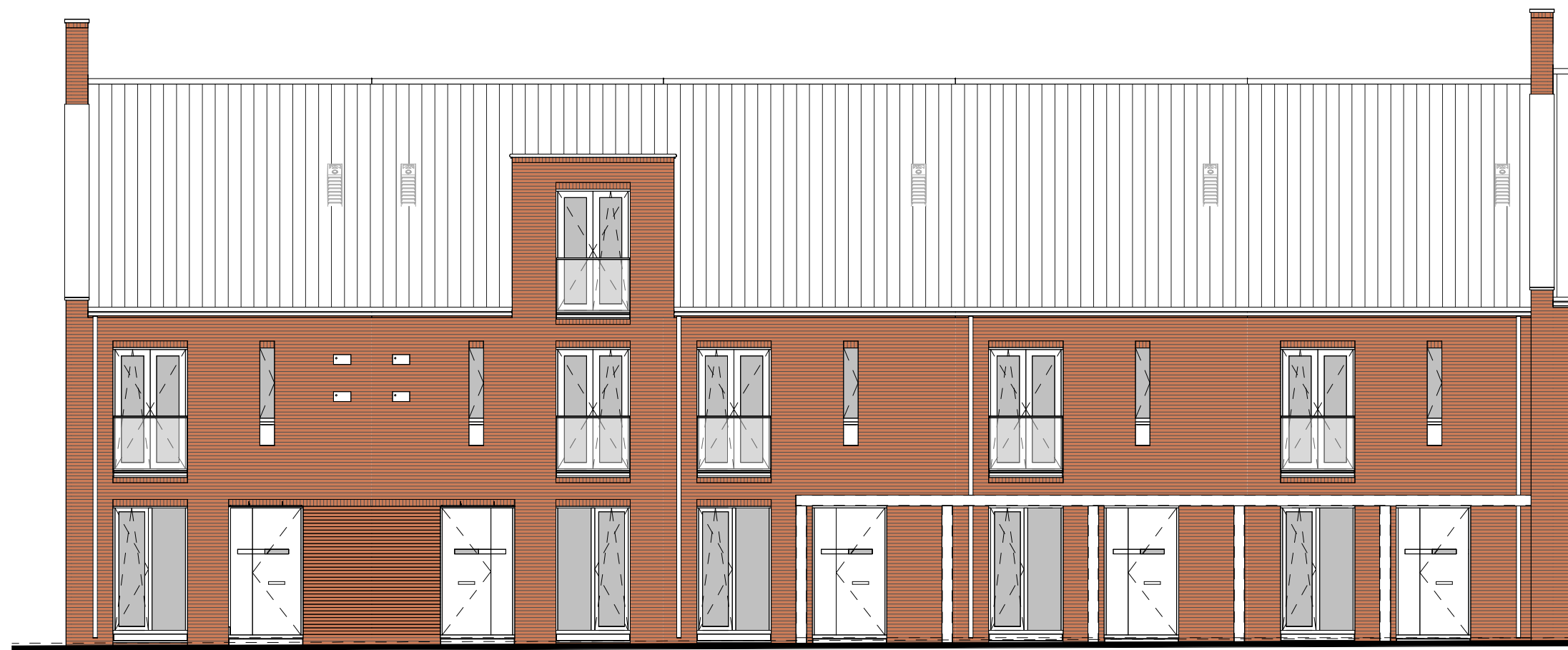
type A1sp bwnr get.:548 type B3 bwnr get.:549 type B4sp bwnr get.:550 type B4sp bwnr get.:551 type B4sp bwnr get.:552 VOORGEVEL 1:50
